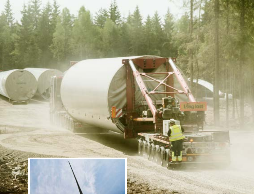
Transporterna är en av de svåra delarna när vindkraftverk ska byggas. Torndelarna kördes till Grimsås med lastbil från hamnen i Karlshamn. Övriga komponenter, inklusive de 65 meter långa vingarna, fraktades från tillverkaren i Danmark.
